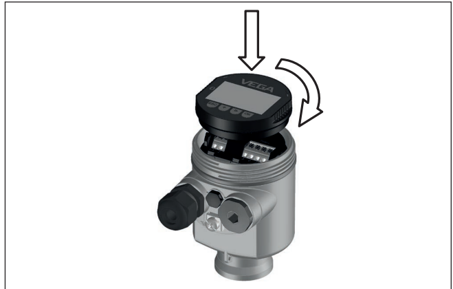
Fig. 31: Empleo del módulo de visualización y configuración en carcasa de una sola cámara el compartimiento de conexión
