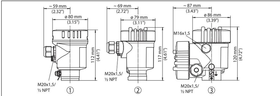
Fig. 46: Variantes de boîtier en protection IP66/IP68 (0,2 bar), (avec un module de réglage et d'affichage intégré, la hauteur du boîtier augmente de 9 mm/0.35 in)
