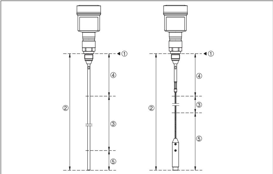
Fig. 33: Plages de mesure - VEGAFLEX 81
