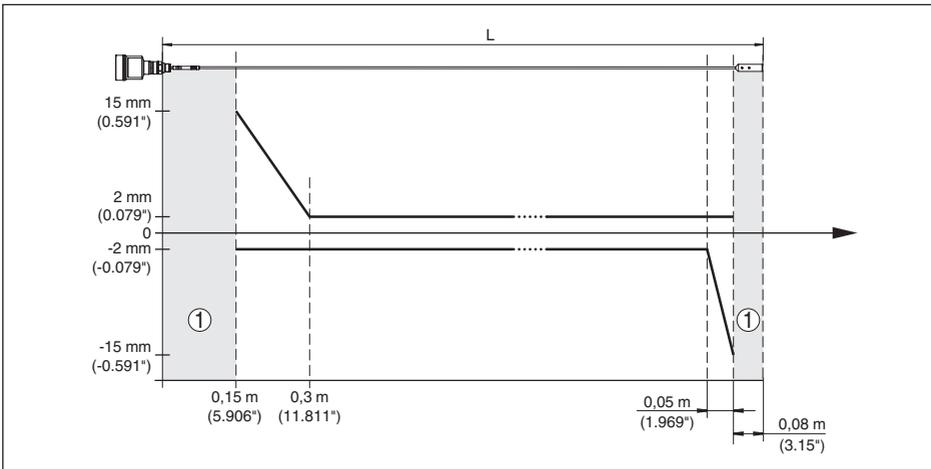
Fig. 37: Écart de mesure VEGAFLEX 81 en version câble (ø 2 mm/0.079 in), dans l'huile
