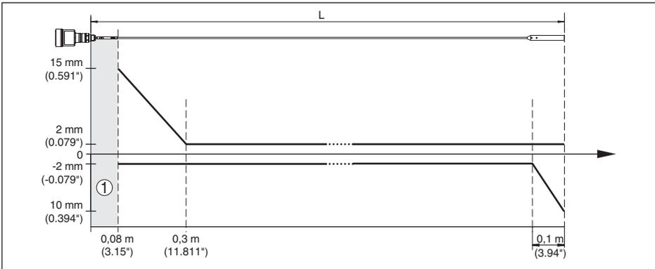
Fig. 36: Écart de mesure VEGAFLEX 81 en version câble dans l'eau
