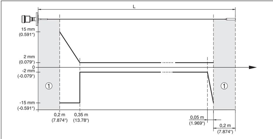
Fig. 40: Écart de mesure VEGAFLEX 81 en version câble (ø 4 mm/0.157 in, revêtu PFA) dans le produit Huile
