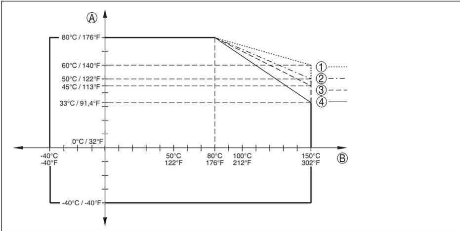
Fig. 41: Température ambiante - température process, version standard
