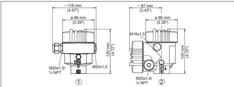
Fig. 44: Variantes de boîtier en protection IP66/IP68 (0,2 bar), (avec un module de réglage et d'affichage intégré, la hauteur du boîtier augmente de 9 mm/0.35 in)
