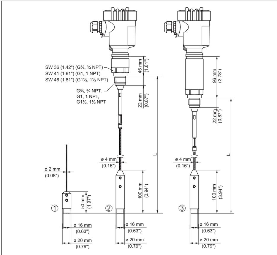
Fig. 48: VEGAFLEX 81, version fileté avec poids tenseur (tous les poids tenseurs avec filetage M8 pour anneau de levage)
