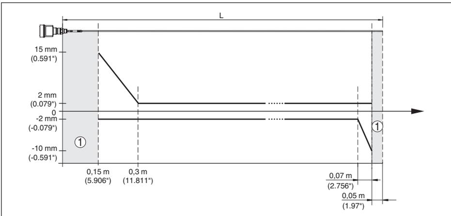
Fig. 35: Écart de mesure VEGAFLEX 81 en version tige dans l'huile
