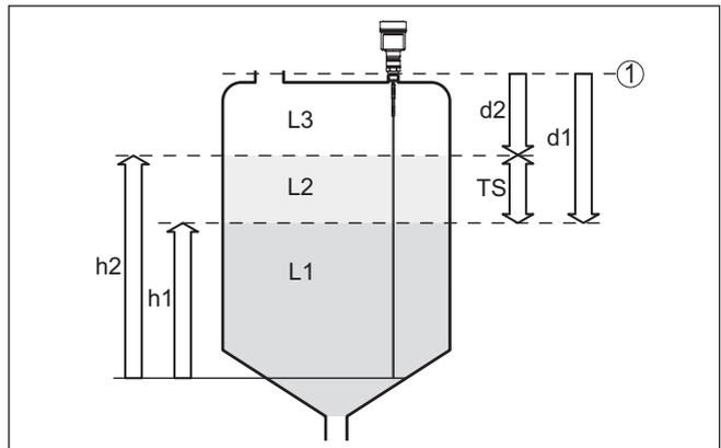
Fig. 2: Mesure d'interface
