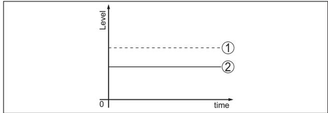
Fig. 30: La ligne en pointillés 1 montre le niveau réel, la ligne continue 2 montre le niveau indiqué par le capteur.
