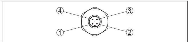
Fig. 17: Vue sur le connecteur M12 x 1
