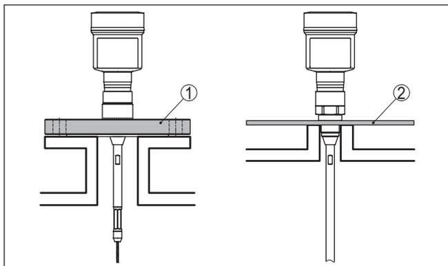
Fig. 4: Montage dans des cuves non métalliques
