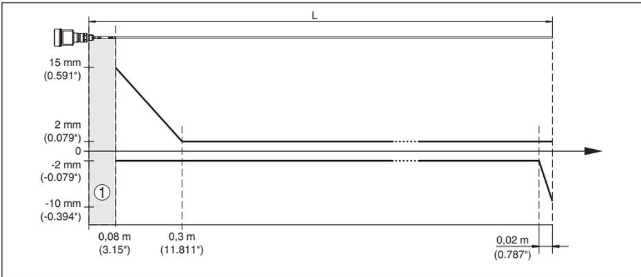
Fig. 34: Écart de mesure VEGAFLEX 81 en version tige dans l'eau
