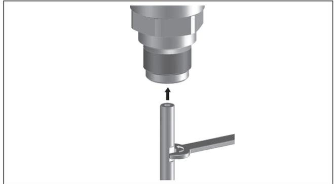
Fig. 31: Changer le câble de mesure ou la tige de mesure
