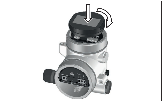
Fig. 13: Insertion du module de réglage et d'affichage
