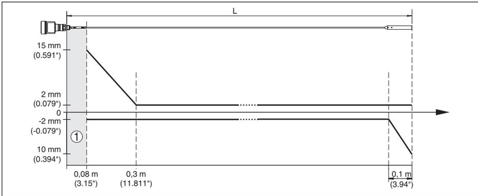
Fig. 37: Écart de mesure VEGAFLEX 81 en version câble dans l'eau
