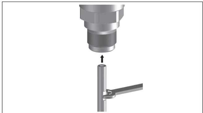
Fig. 32: Changer le câble de mesure ou la tige de mesure
