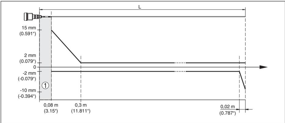
Fig. 35: Écart de mesure VEGAFLEX 81 en version tige dans l'eau
