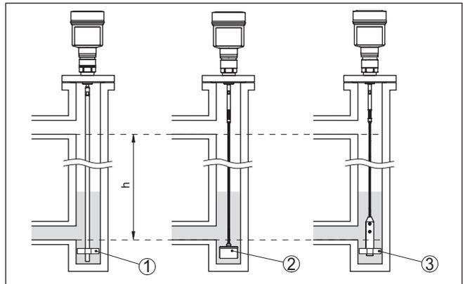
Fig. 9: Montage dans un tube bypass - Position de l'étoile de centrage ou du poids de centrage
