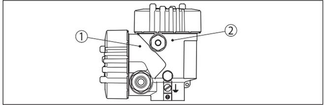
Fig. 14: Position du compartiment de raccordement (électronique du Modbus) et du compartiment de l'électronique (électronique du capteur)
