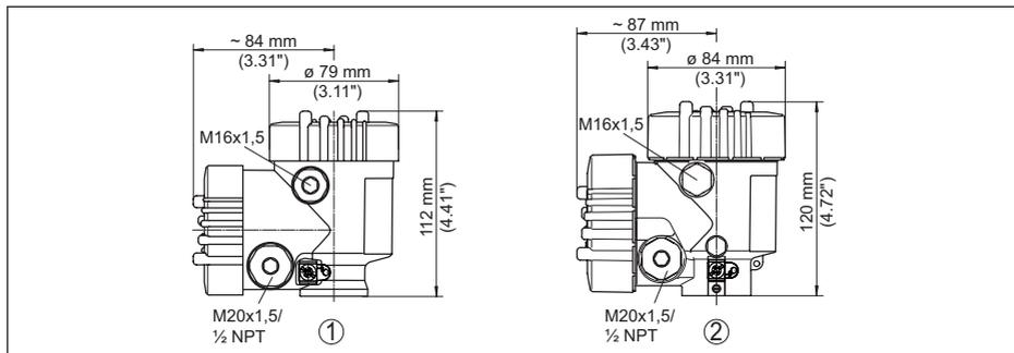
Fig. 45: Dimensions du boîtier (avec un module de réglage et d'affichage intégré, la hauteur du boîtier augmente de 9 mm/0.35 in)
