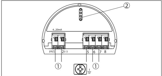
Fig. 15: Compartiment électronique - boîtier à deux chambres
