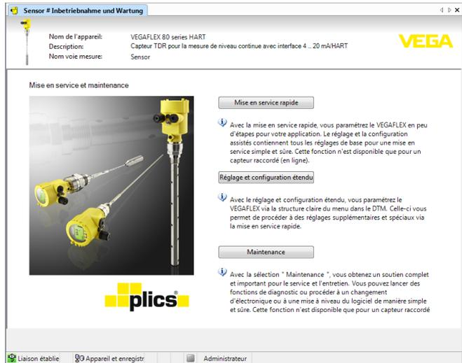
Fig. 29: Sélectionner la mise en marche rapide
