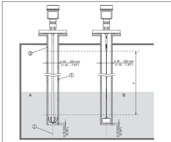
Fig. 10: Montage dans un tube tranquillisateur
