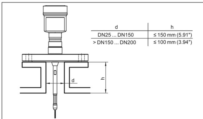
Fig. 6: Rehausse de montage
