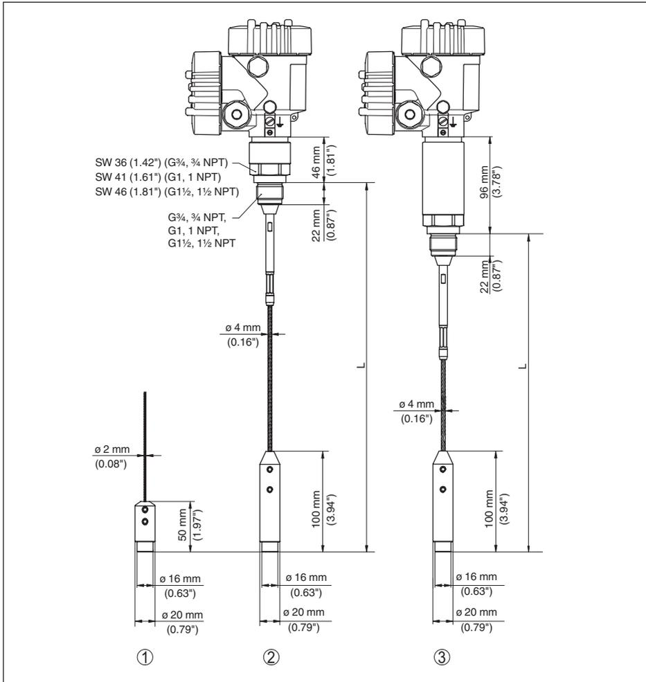
Fig. 46: VEGAFLEX 81, version fileté avec poids tenseur (tous les poids tenseurs avec filetage M8 pour anneau de levage)
