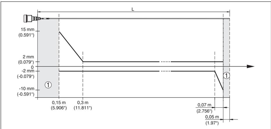
Fig. 36: Écart de mesure VEGAFLEX 81 en version tige dans l'huile
