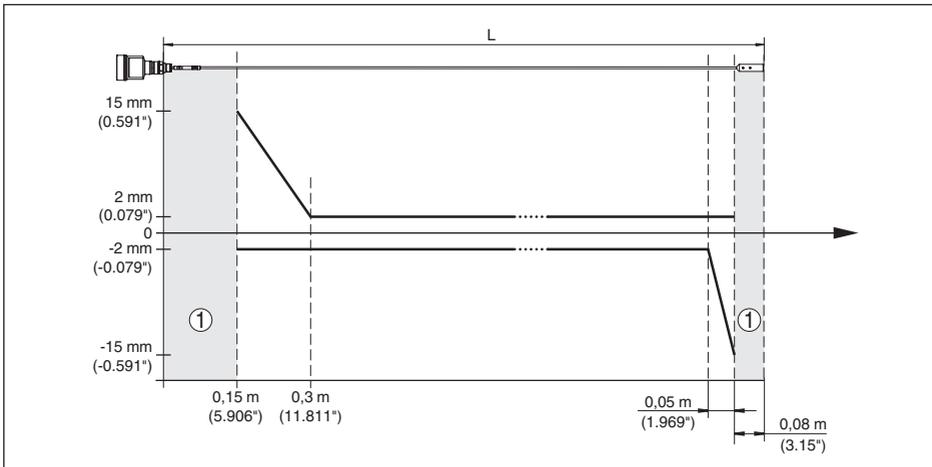
Fig. 38: Écart de mesure VEGAFLEX 81 en version câble (ø 2 mm/0.079 in), dans l'huile
