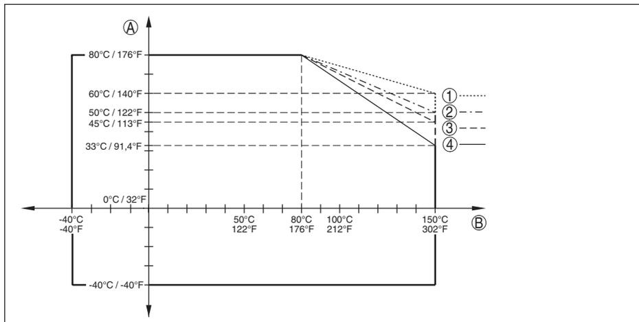
Fig. 42: Température ambiante - température process, version standard
