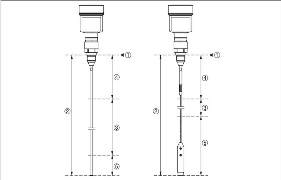
Fig. 34: Plages de mesure - VEGAFLEX 81
