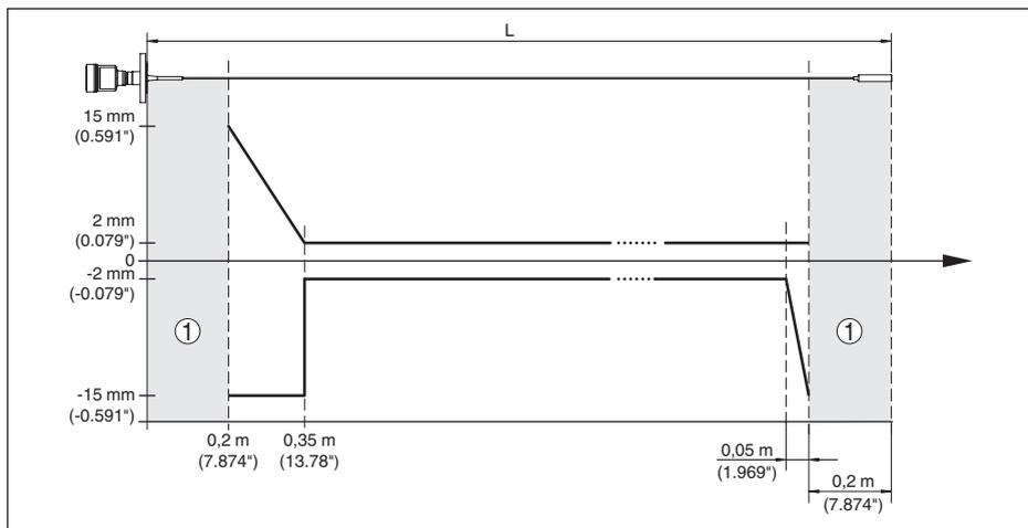
Fig. 41: Écart de mesure VEGAFLEX 81 en version câble ( $\varnothing$  4 mm/0.157 in, revêtu PFA) dans le produit Huile
