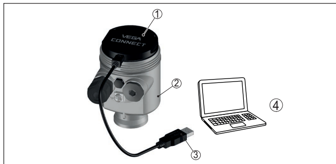
Fig. 36: Conexión del PC vía VEGACONNECT y USB
