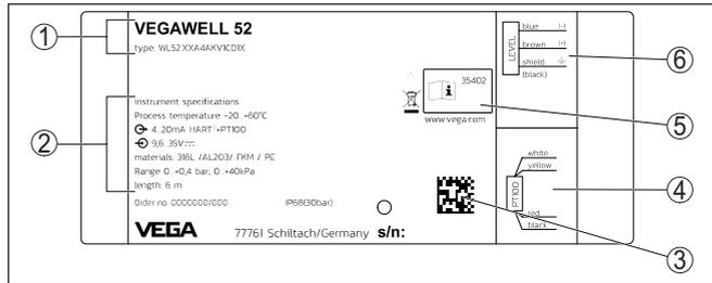
Fig. 2: Présentation de la plaque signalétique (exemple)
