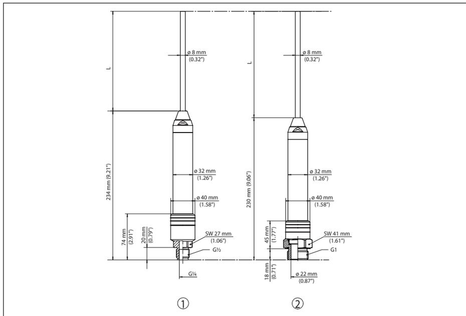
Fig. 19: VEGAWELL 52, avec raccord fileté et capteur de mesure acier Duplex (1.4462)
