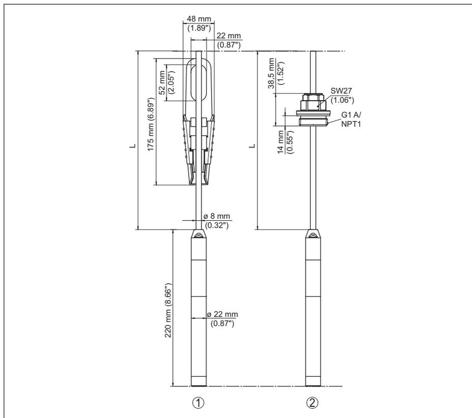
Fig. 16: VEGAWELL 52, avec capteur de mesure 316L/titane 22 mm
