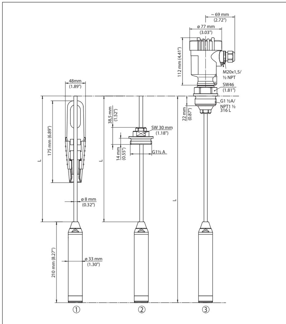
Fig. 17: VEGAWELL 52, avec capteur de mesure titane 33 mm
