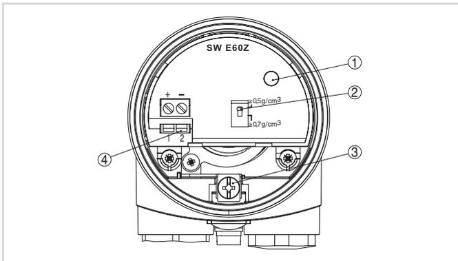
Compartimento de la electrónica y de conexiones carcasa de una cámara
