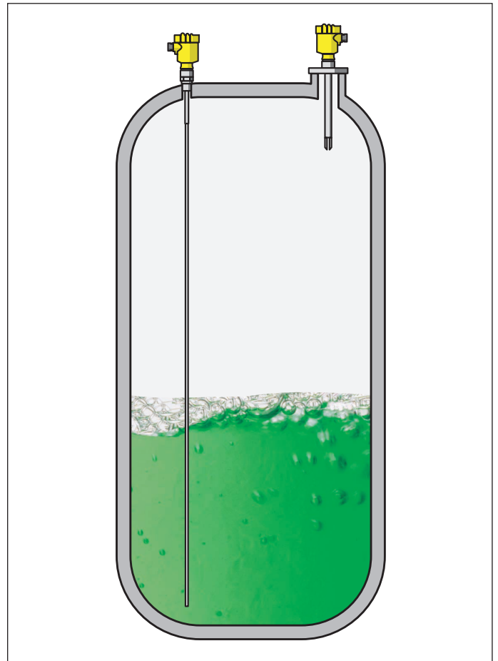
Fig. 2: Detección de nivel en depósitos de disolventes
