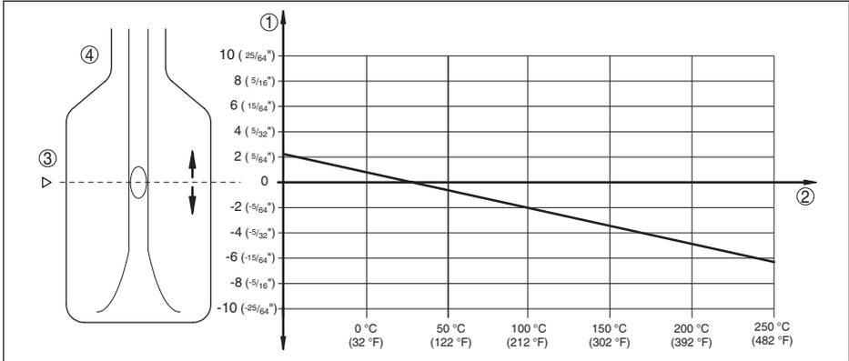
Fig. 14: Influencia de la temperatura de proceso sobre el punto de conmutación
