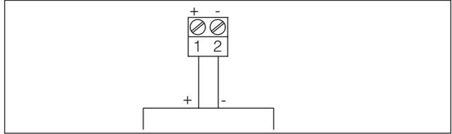
Fig. 11: Esquema de conexión para carcasa de una cámara
