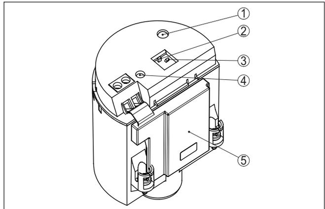
Fig. 13: Módulo electrónico SWE60N - Salida NAMUR
