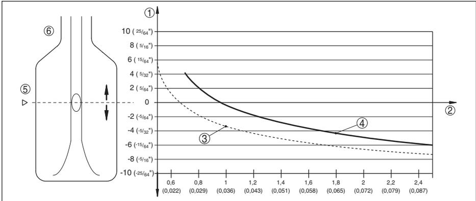
Fig. 15: Influencia de la densidad del producto sobre el punto de conmutación
