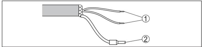
Fig. 12: Ocupación de conductores del cable de conexión
